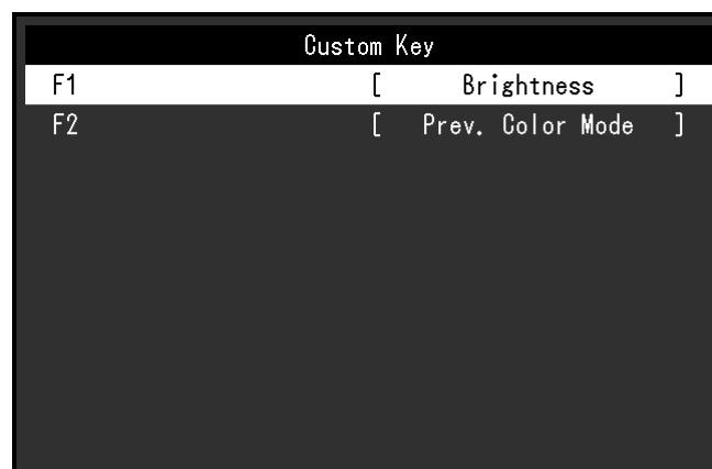
4. Pomocí tlačítek **Λ** **∨** vyberte funkční tlačítko, ke kterému chcete přiřadit funkci, a zvolte **✓**.
