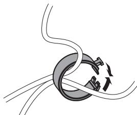
**3. Držák kabelu podržte uzavřený a vložte jej do stojanu.**
