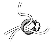
3. Maintenez le serre-câbles fermé et insérez-le dans le socle.
