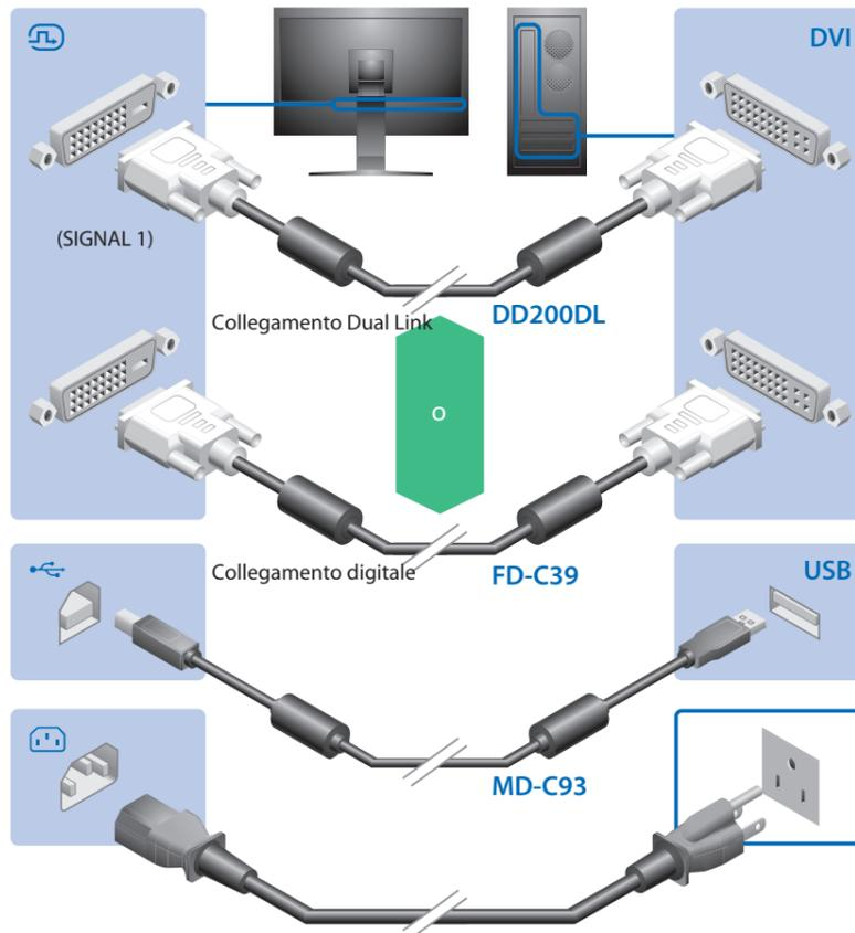
\*Il cavo USB è necessario per realizzare la calibratura. Assicurarsi di aver collegato il monitor e il PC con il cavo USB.
