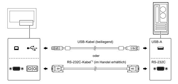
\*1 Kreuztyp. Der Anschluss des Monitors ist ein 9-poliger D-Sub-Anschluss.
