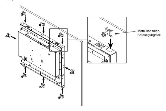
3. Ziehen Sie die Schrauben für die Metallkonsolen-Befestigungsteile mit dem vorgeschriebenen Drehmoment (0,6 N-m - 0,7 N·m) an, um sie zu befestigen.
